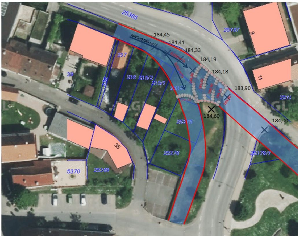
Abbildung 3: Schematische Systemskizze längsdurchgängiges Drosselbauwerk
